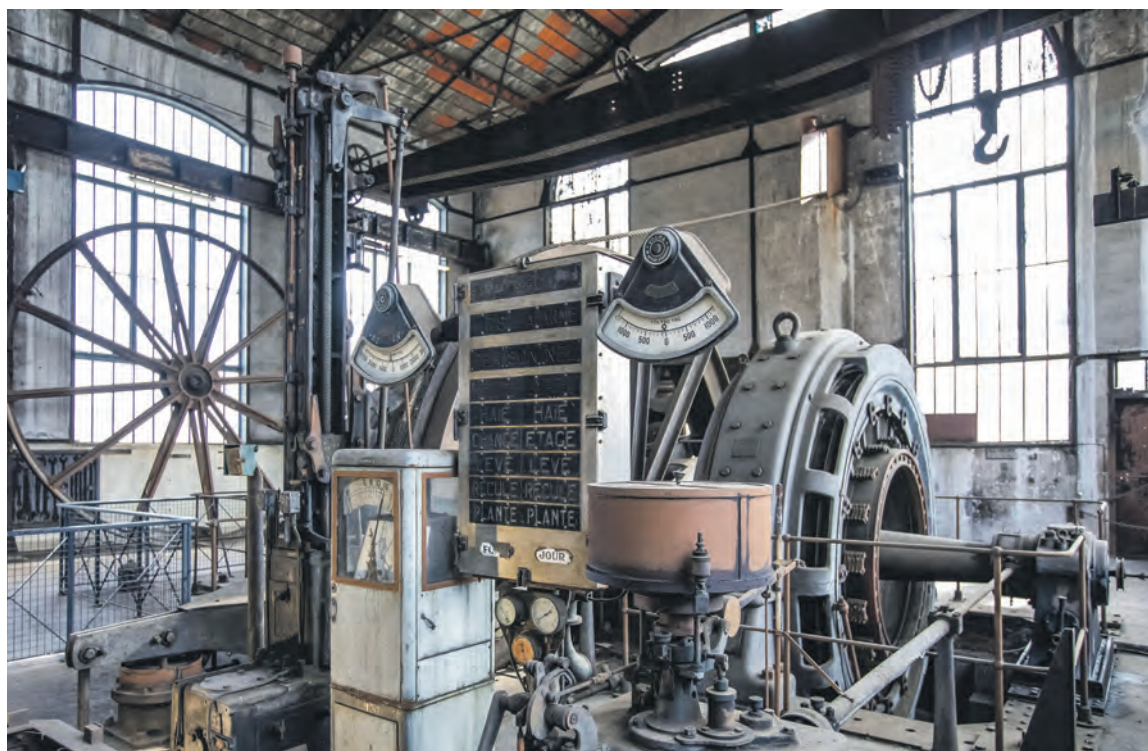
Les bennes chargées de charbon remontaient à la surface grâce à cette « machine d'extraction »
